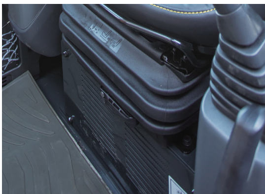
空调滤芯位置变更至座椅下方，滤芯更换、维护便利
